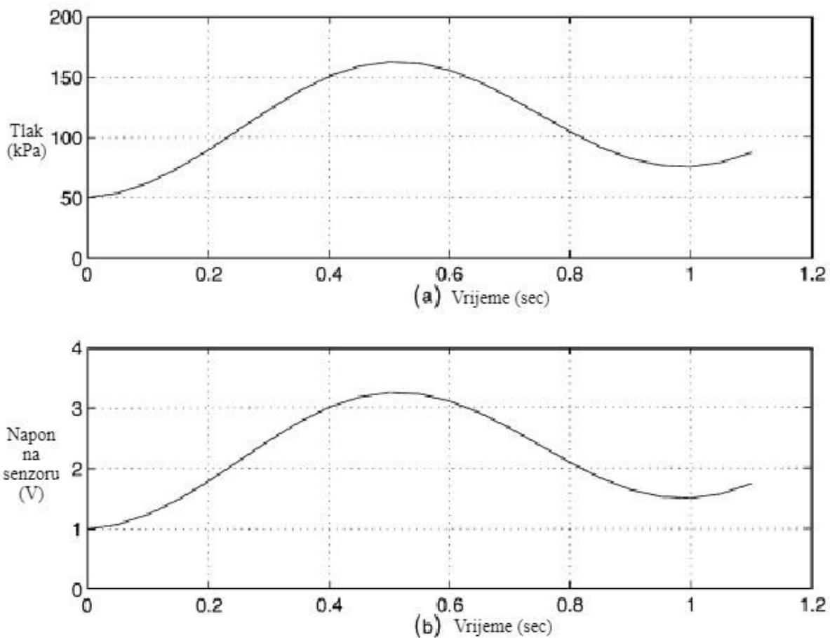
*Slika 10.5.: Usporedba izlaznog napona ovisno o tlaku u sustavu*<sup>18</sup>
