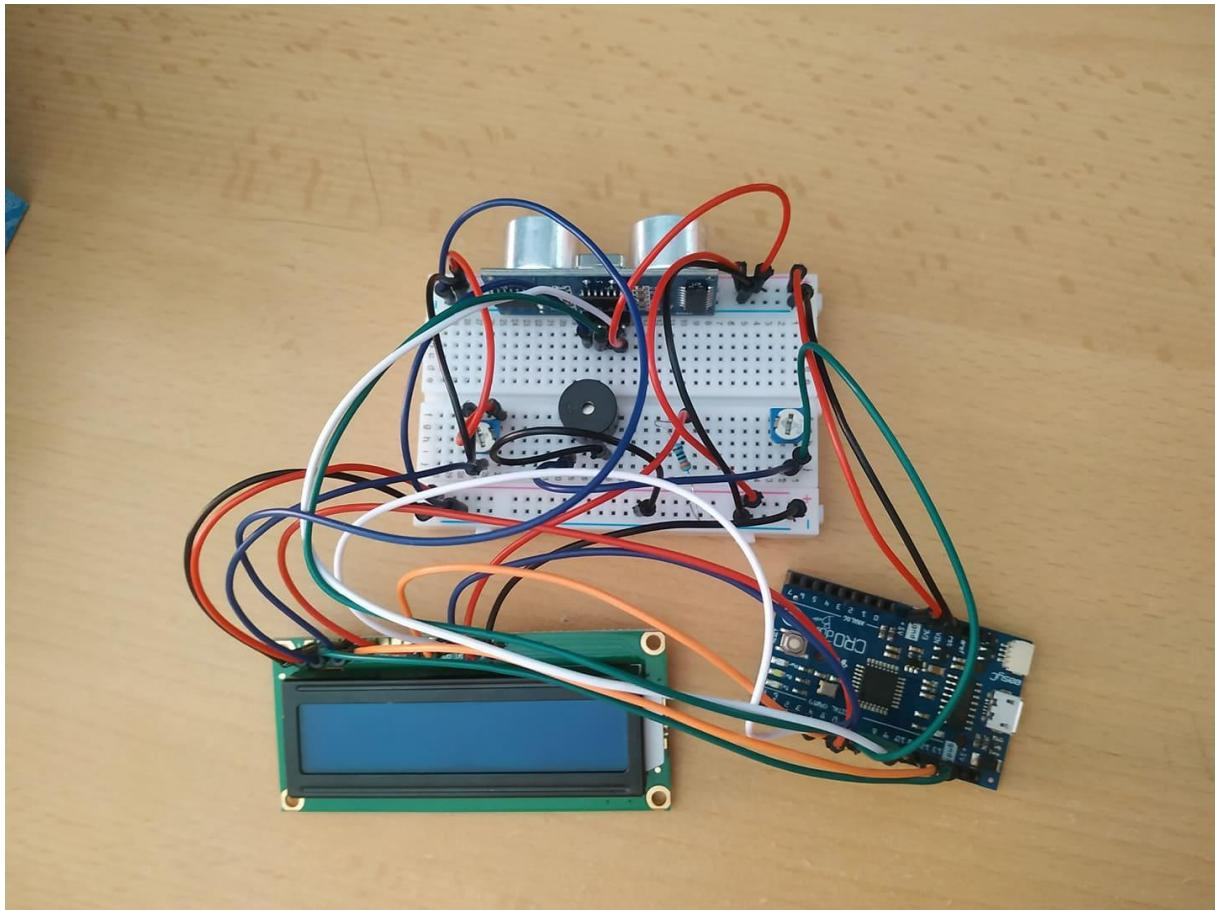
*Slika 12.7.: Prikaz realiziranog sustava za detekciju objekata*
