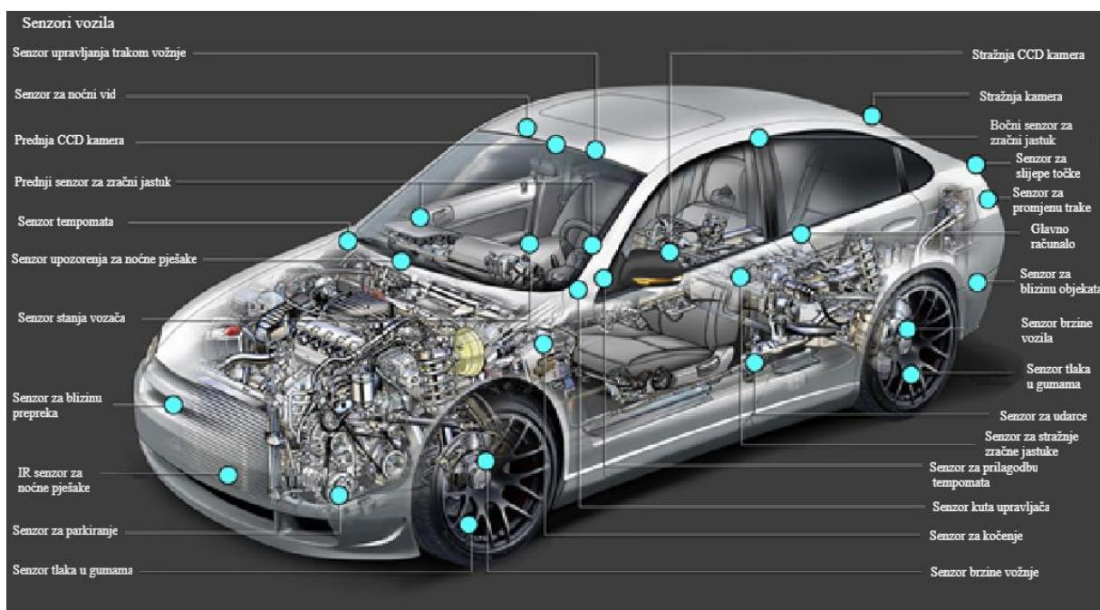
*Slika 7.1.: Senzori u automobilu<sup>11</sup>*
