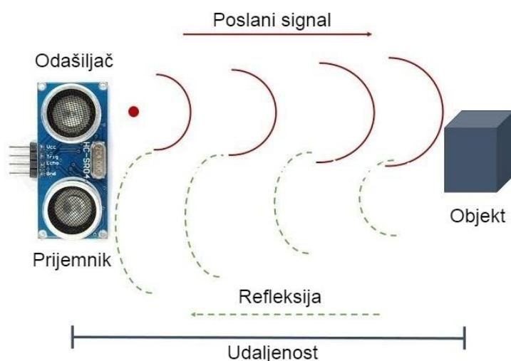
*Slika 12.3.: Princip rada HC-SR04 senzora*<sup>22</sup>
