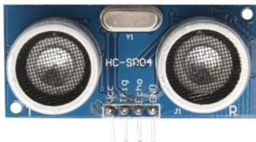
*Slika 12.2.: HC-SR04 ultrazvučni modul*<sup>21</sup>
