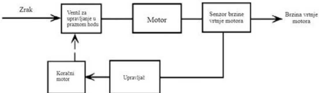
*Slika 10.3.: Dijagram senzora za kontrolu zračnog ventila<sup>16</sup>*
