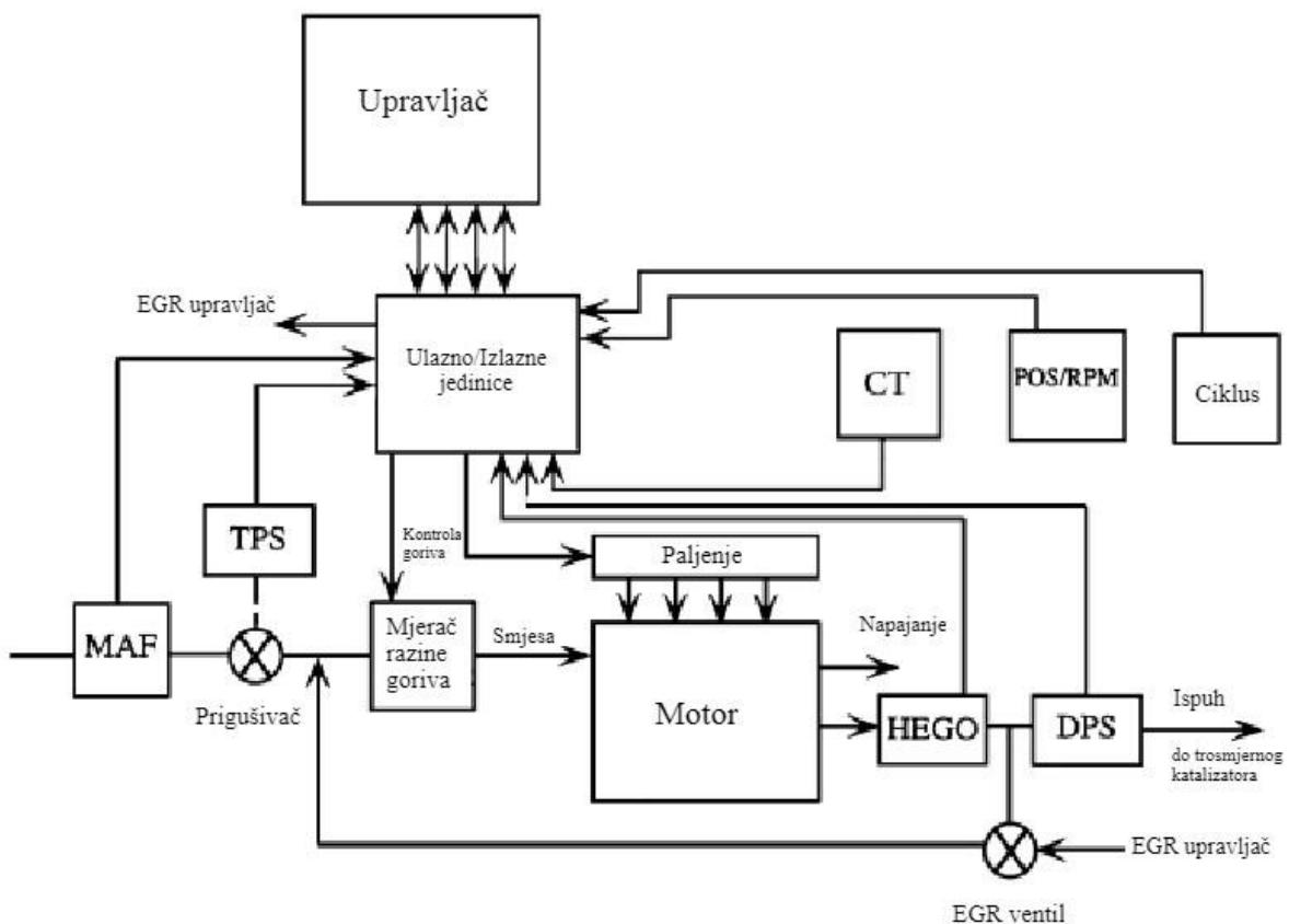
*Slika 10.1.: Digitalni upravljački sustav<sup>14</sup>*
