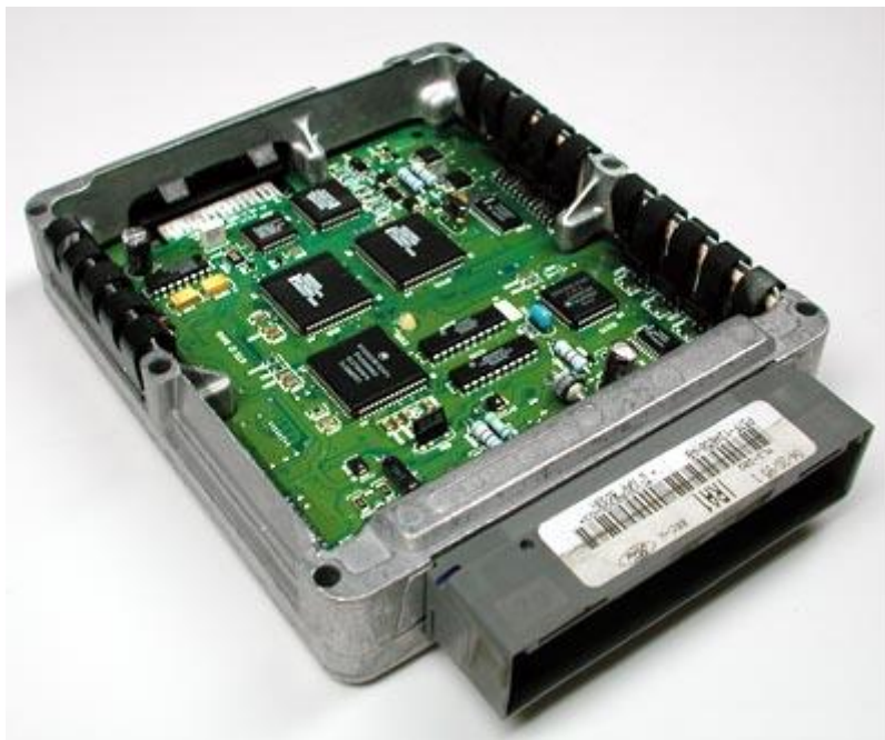
Slika 2.1.: Glavno računalo iz Ford Ranger automobila 1
