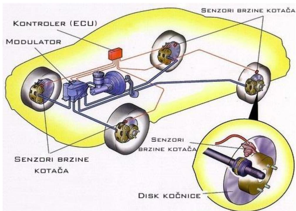
*Slika 6.1.: Dijelovi ABS-a<sup>10</sup>*
