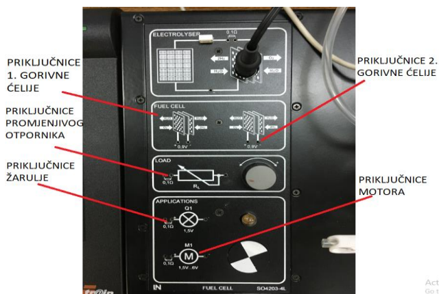
Slika 2.3 Gorivna ćelija na Lucas Nülle maketi (lijevo) i priključnice komponenti (desno)
