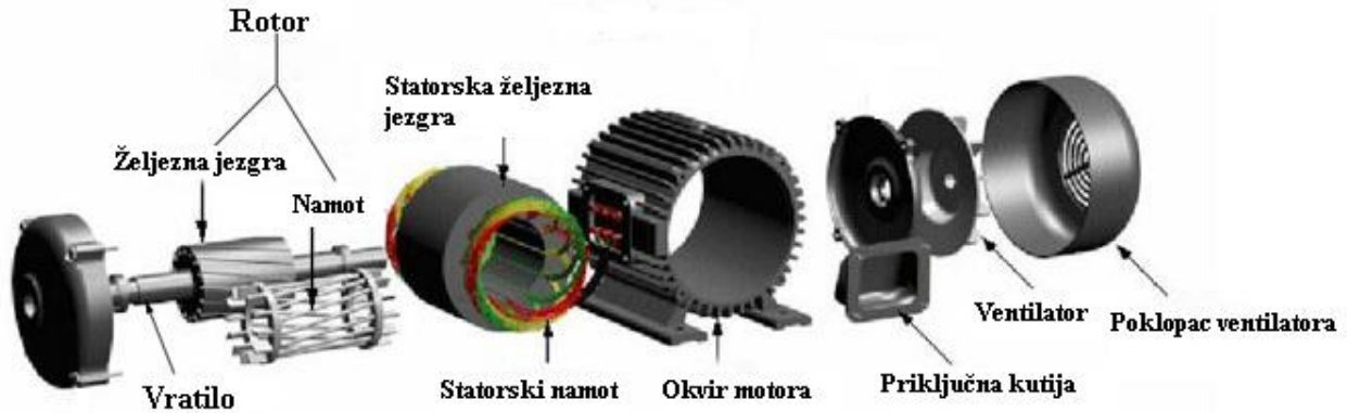
Slika 5.1 Građa asinkronog motora [8]
