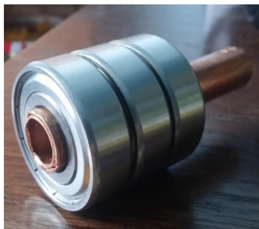
Slika 3.2. Bakrena cijev sa tri kuglična ležaja
