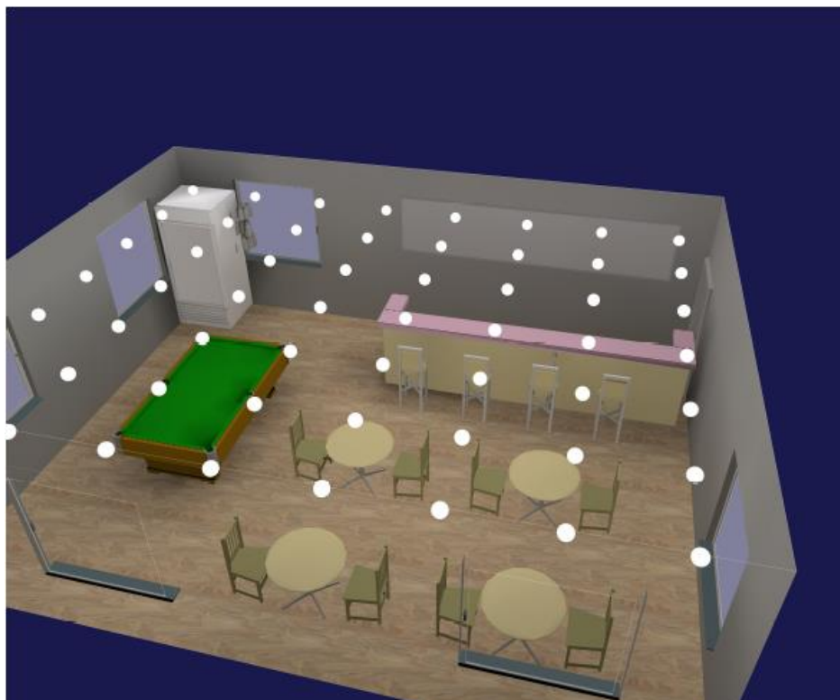
Slika 5.4. 3D model sa halogenim žaruljama[P.5.1.]
