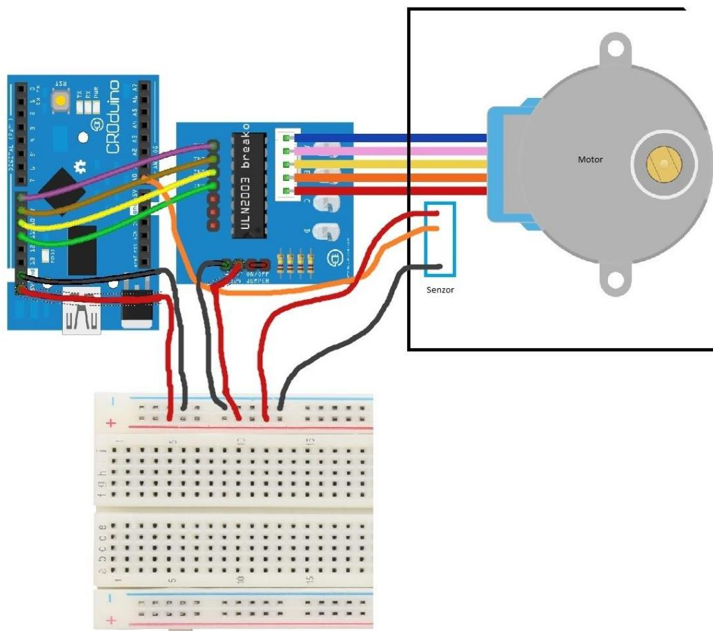
**Slika 3.12.** Montažna shema spajanja senzora zajedno s motorom
