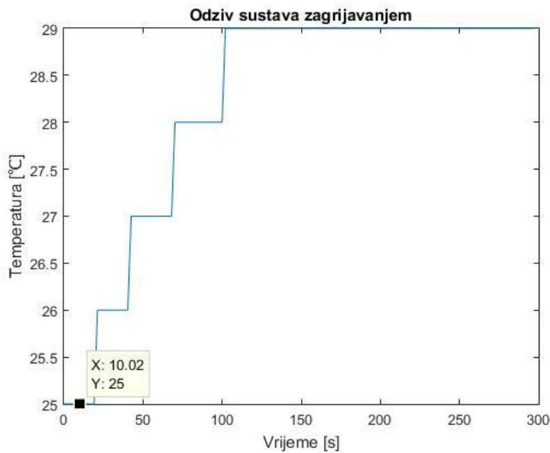
Slika 4.1. Rezultati testiranja sustava u režimu rada grijanja
