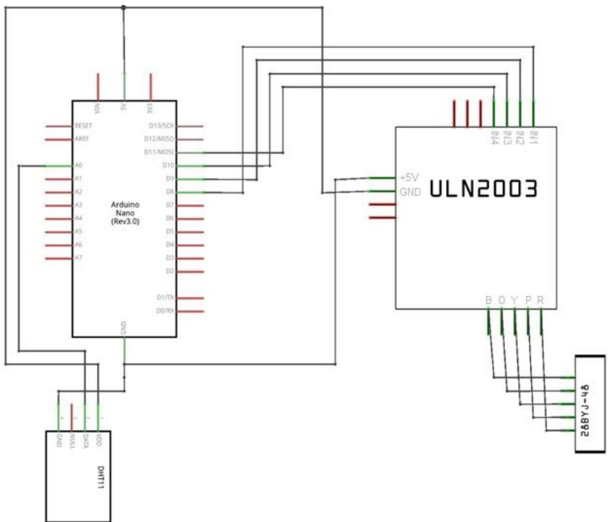
Slika 3.13 Električna shema spajanja senzora zajedno s motorom
