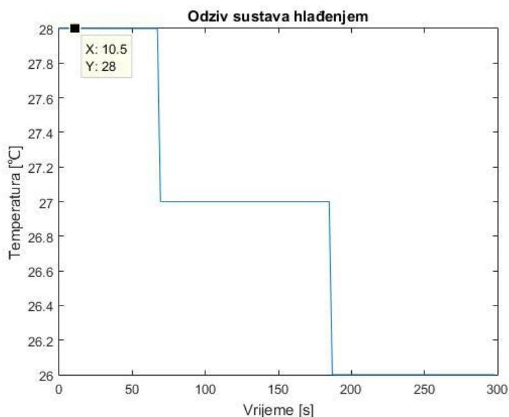
Slika 4.2. Rezultati testiranja sustava u režimu rada hlađenja
