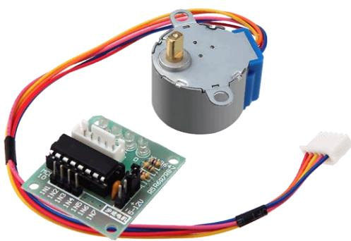
Slika 3.3. 28byj-48 motor sa ULN2003 pokretačem
