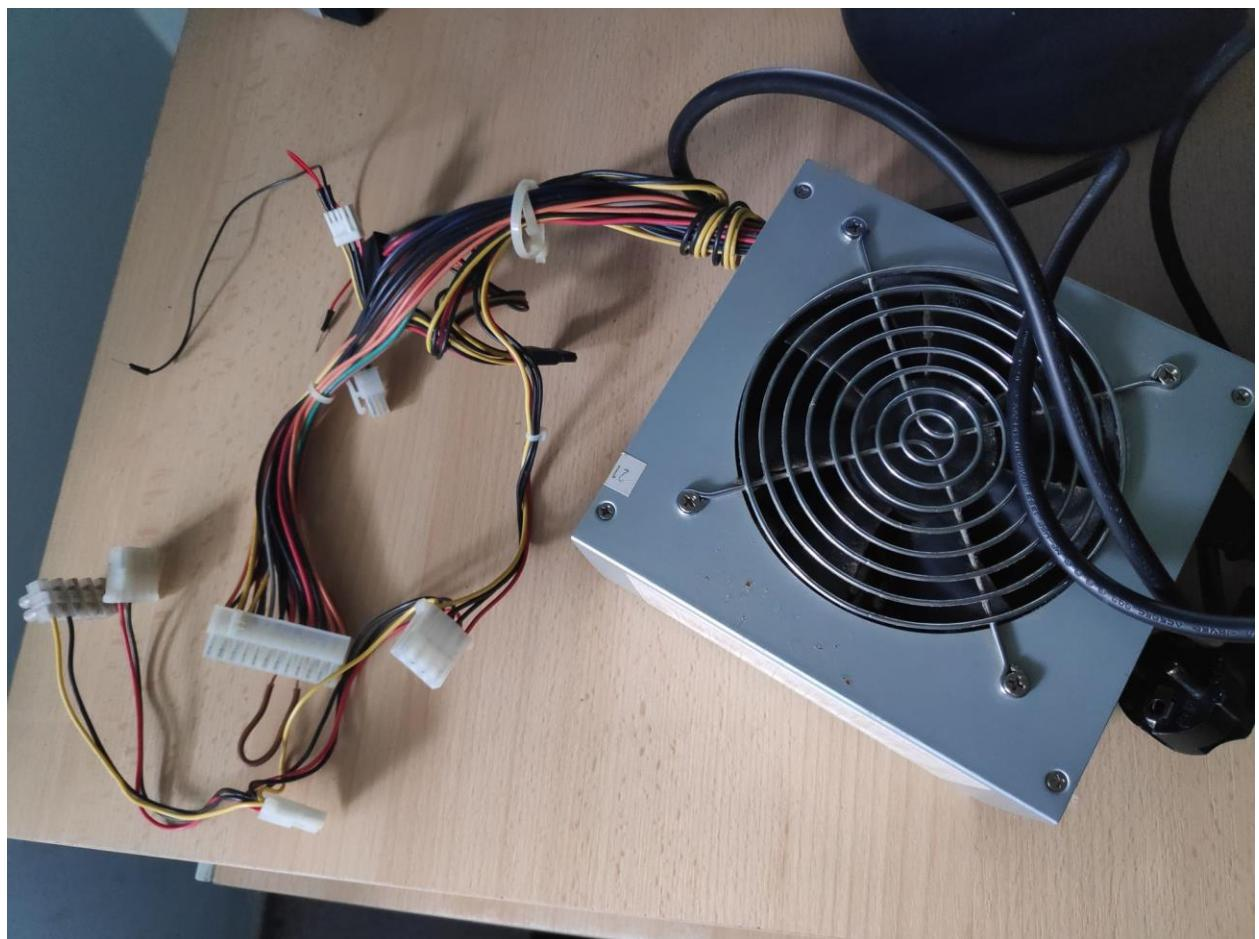
**Slika 3.2.** Računalno napajanje
