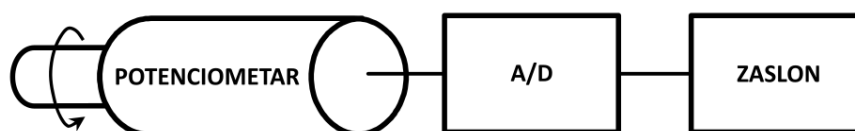
Slika 2.7 - Mjerenje i prikaz rotacijskog pomaka korištenjem potencijometra [1]
