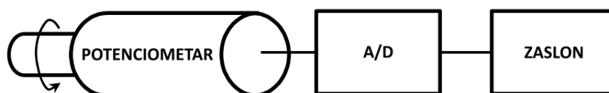
Slika 2.7 - Mjerenje i prikaz rotacijskog pomaka korištenjem potencijometra [1]
