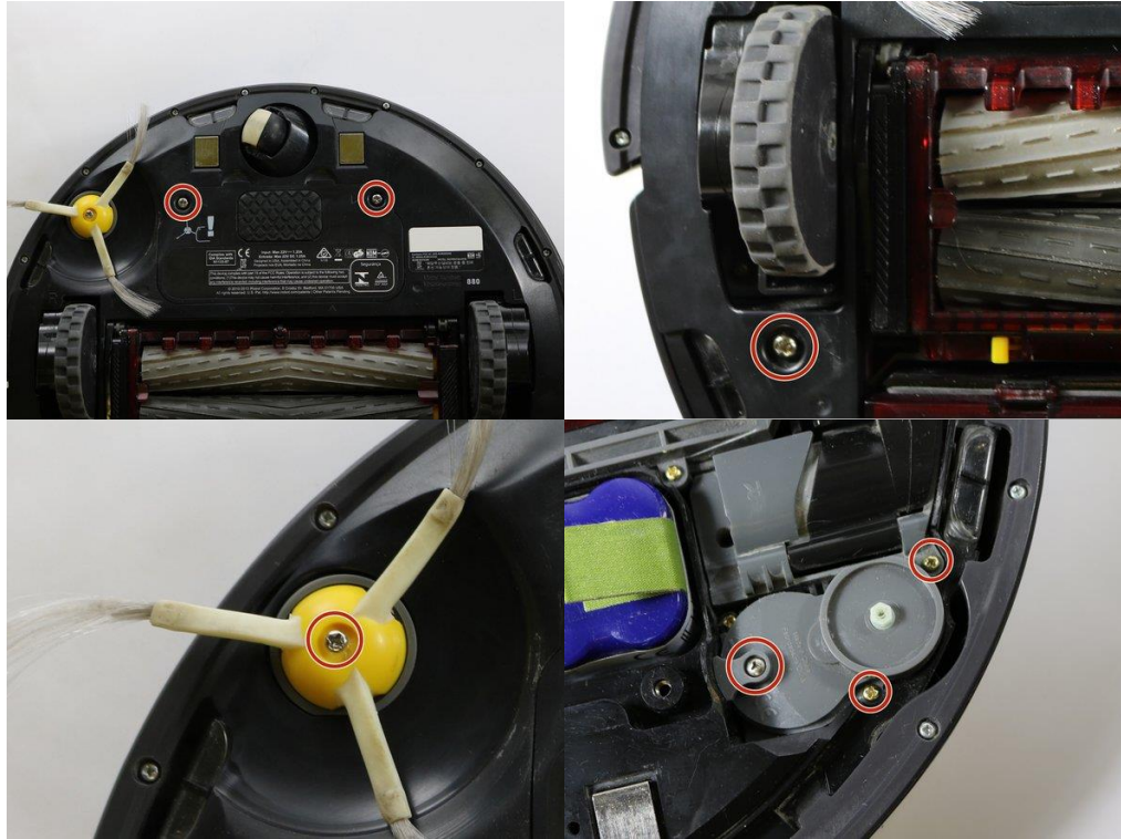
Sl. 5.2.4. Primjena fotodokumentacije za praćenje lokacije određenih vijaka, [23]
