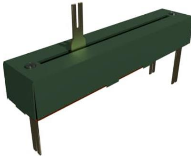
Slika 6.6. Prikaz linearnog potencijometra [10]
