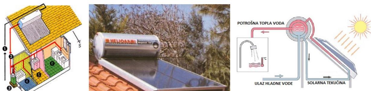
Slika 3.1. Primjer sustava s prirodnom cirkulacijom [2]
