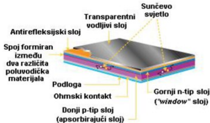
Slika 4.4. Struktura polikristalne tankoslojne FN ćelije [5]
