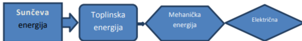
Slika 3.4. Slijed pretvorbe energije u solarnoj termoelektrani [9]
