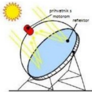
Slika 3.9. Koncept koncentriranja sunčevih zraka kod tanjurastog paraboličnog kolektora [13]
