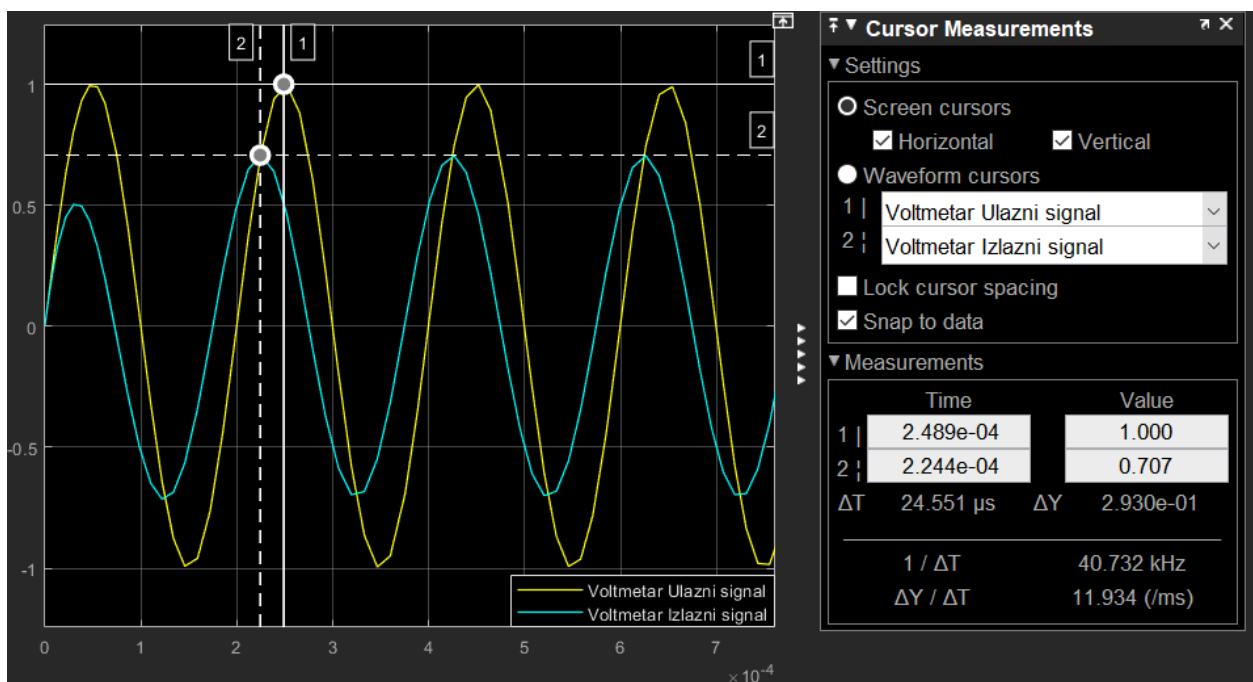
Slika 3.21. Visoko propusni CR filter s monoharmonijskim ulaznim signalom frekvencije 5004\text{ Hz}
