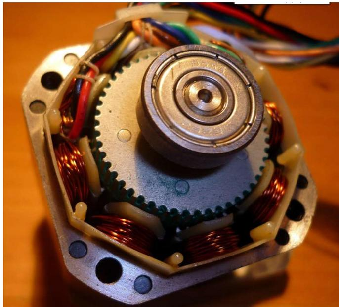
Slika 3.10. Unutarnji izgled step motora [18]
