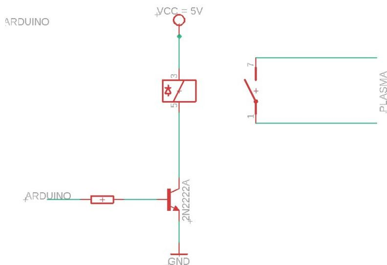
**Slika 3.6.** Shema spajanja kruga za paljenje elektrode
