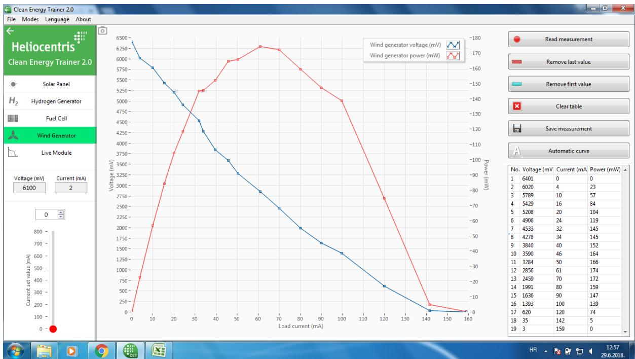
Slika 4.5. 3 lopatice,  $60^\circ$  prema osovini, snaga vjetra ventilatora 2
