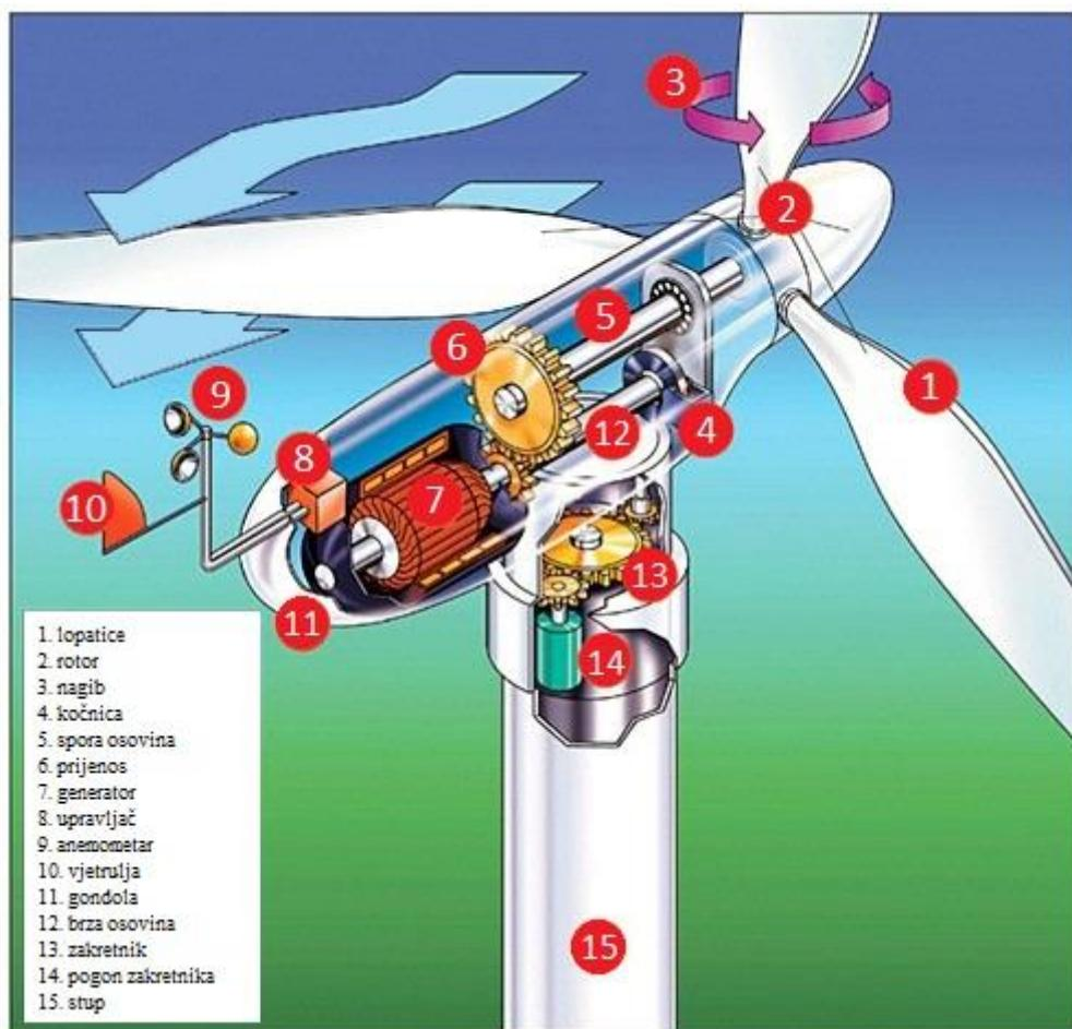
**Slika 2.4.** Dijelovi vjetroturbine
