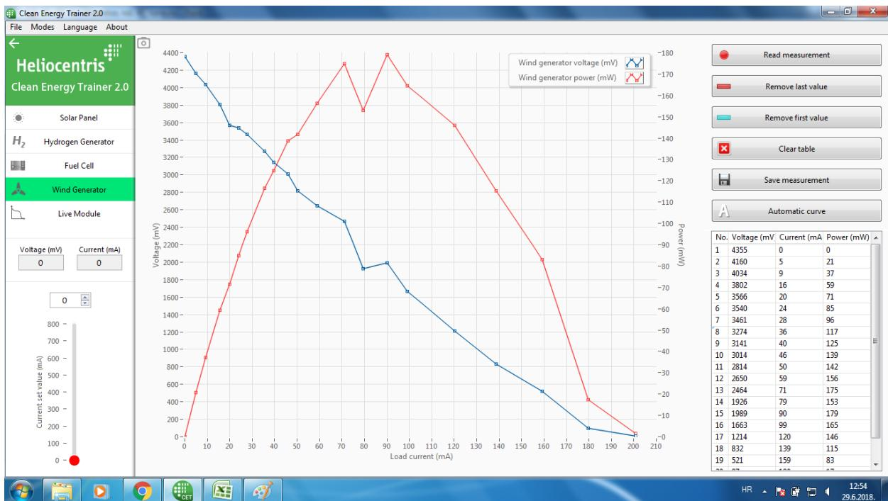
Slika 4.4. 3 lopatice,  $45^\circ$  prema osovini, snaga vjetra ventilatora 2
