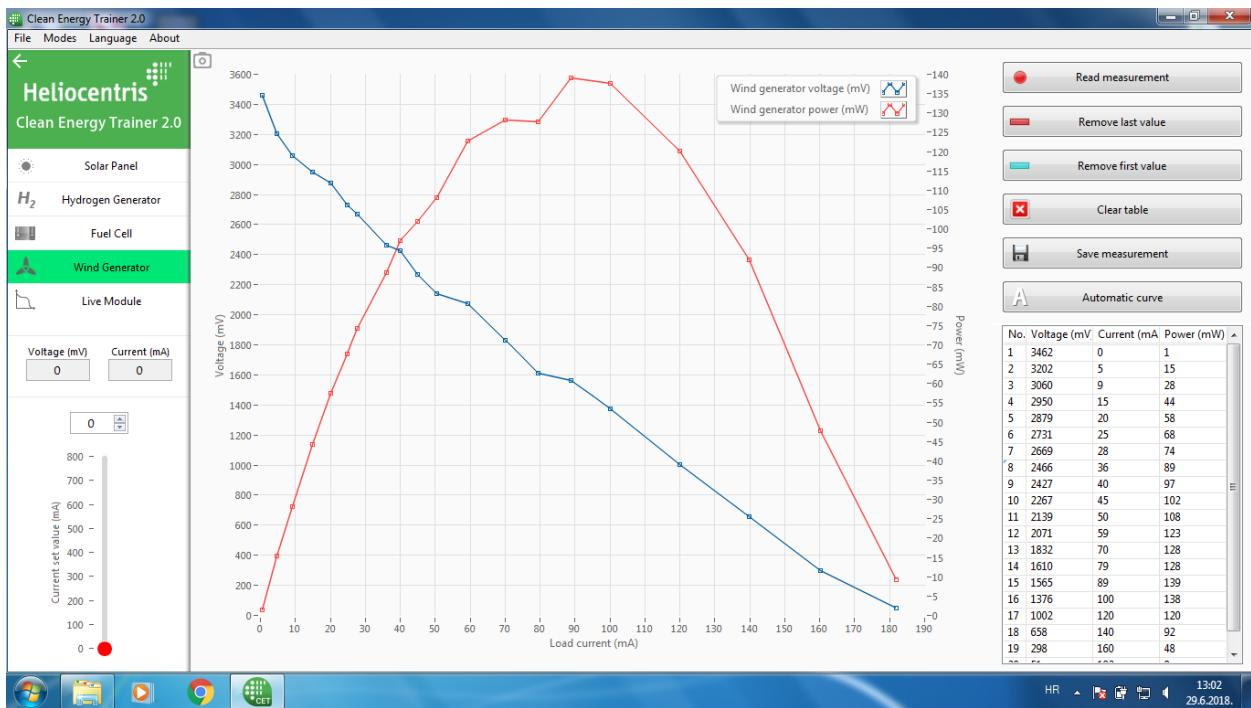
Slika 4.3. 3 lopatice,  $30^\circ$  prema osovini, snaga vjetra ventilatora 2
