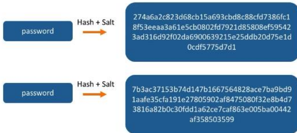
Slika 4.7. Prikaz primjene algoritma sa začinom za dvije iste lozinke
