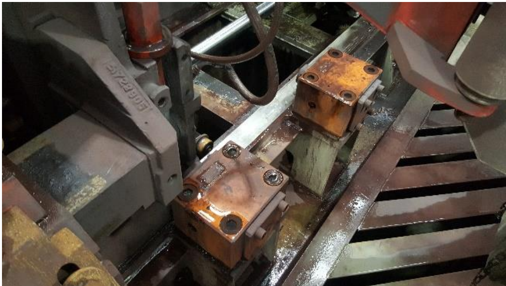
Slika 4.2 Dva stezna klina sa suprotne strane stana
