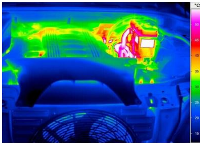
Sl.5.5.1. Termogram motora automobila [22]
