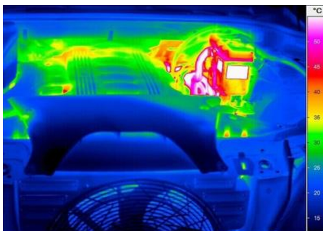
Sl.5.5.1. Termogram motora automobila [22]
