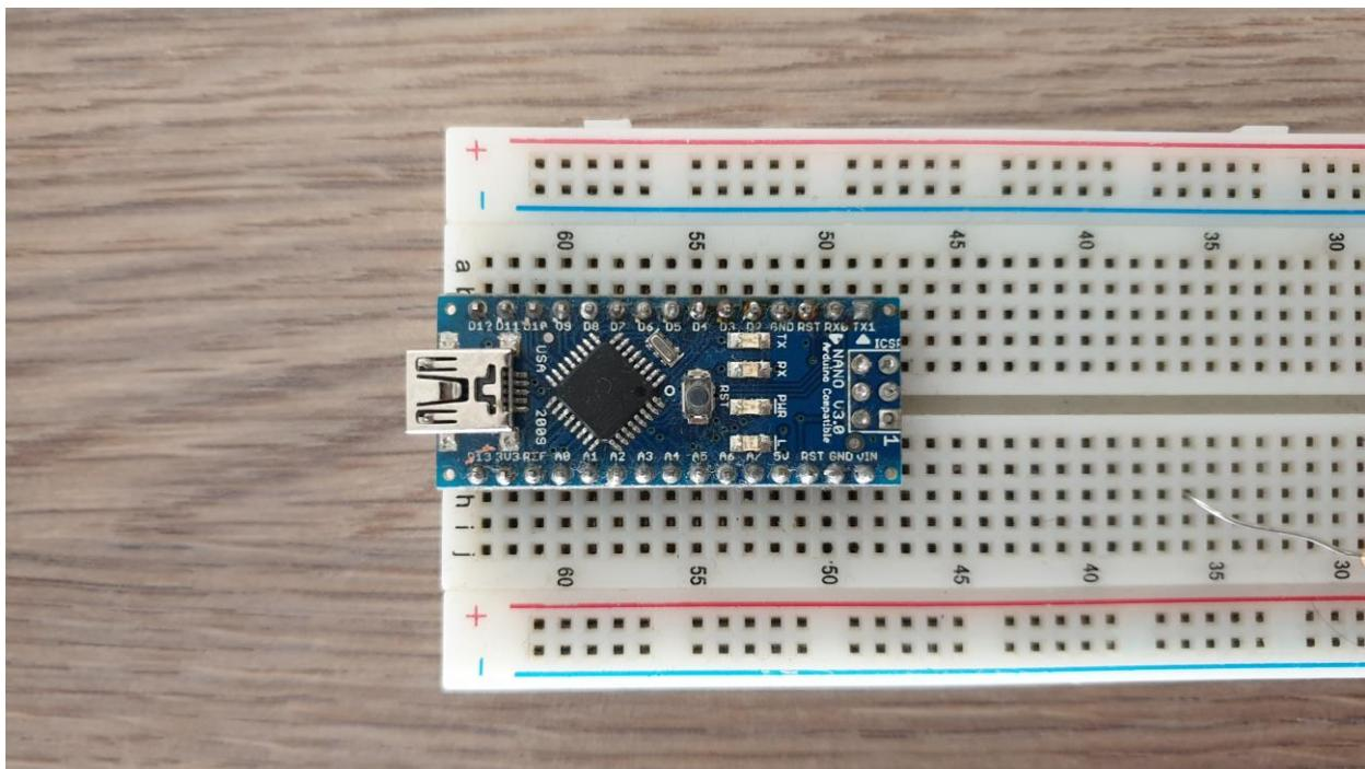
Slika 2.1. Arduino Nano sklopolje sa Atmega328P mikroprocesorom.
