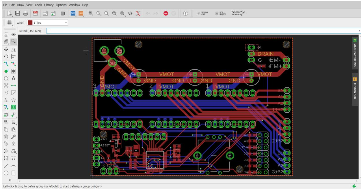
*Slika 2.10. Dizajn tiskane pločice u programu Eagle.*
