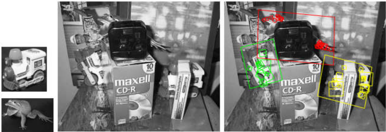
Slika 2.3. Primjer prepoznavanja objekata i označavanje, korišten SIFT algoritam
