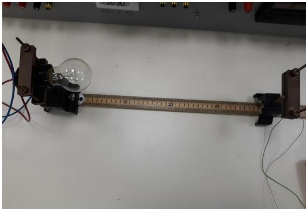
Mjerenje duljine pomoću fotootpora
