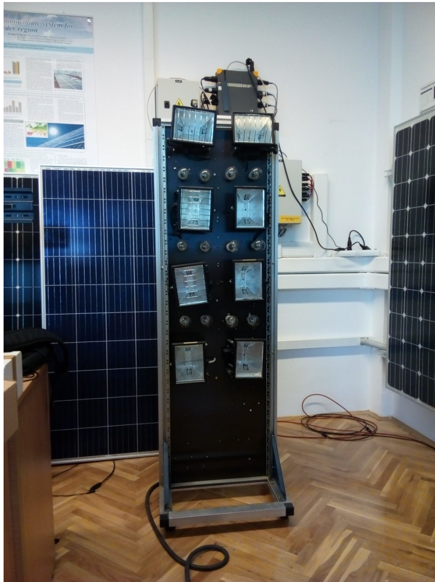
Slika 4.2. Umjetni izvor Sunčevog zračenja snage 5 kW
