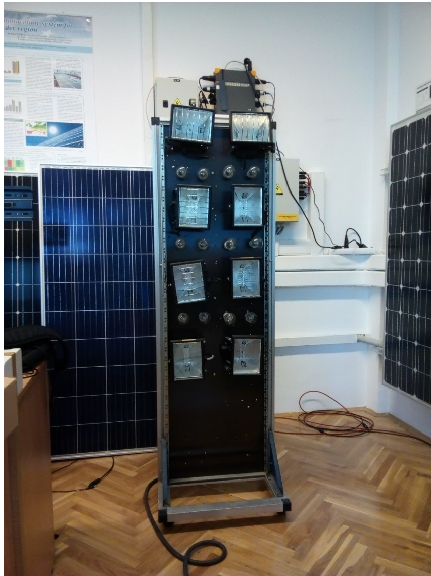
Slika 4.2. Umjetni izvor Sunčevog zračenja snage 5 kW
