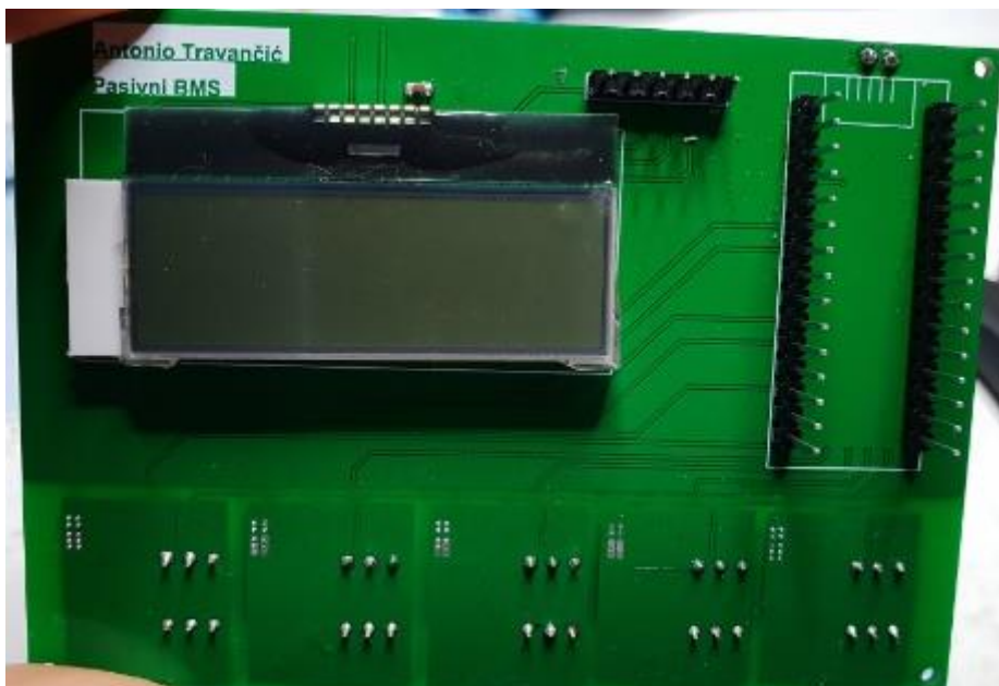
Slika 3.17. Donja strana tiskane pasivnog sustava balansiranja baterijskih ćelija [32]
