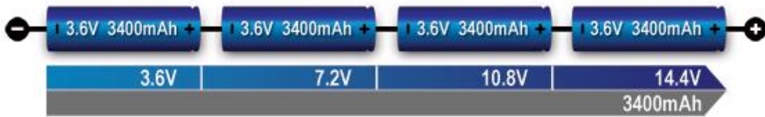
Slika 2.7. Serijski spoj četiri baterijske ćelije [19]
