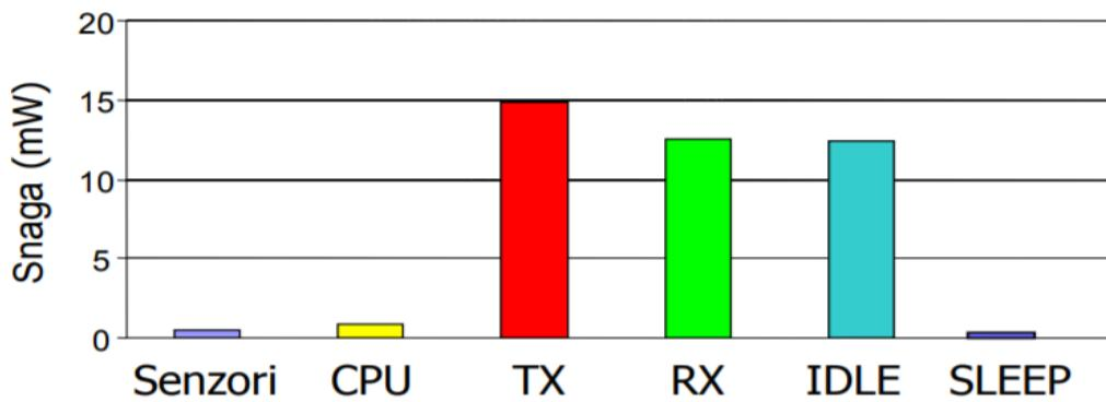
**Slika 2.1 Prikaz utroška energije pojedinog senzorskog čvora [2]**
