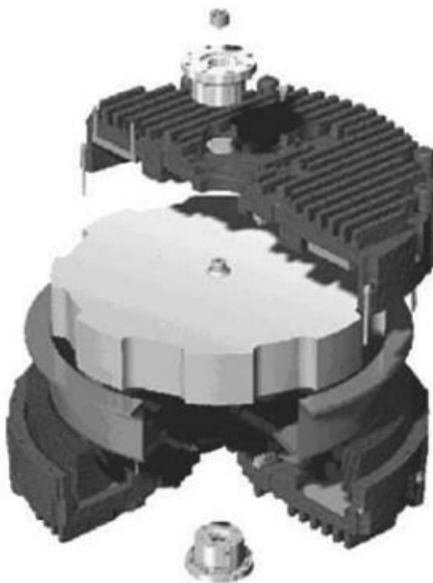
Slika 5.8. Zamašnjak za pohranu energije [1, str.69]
