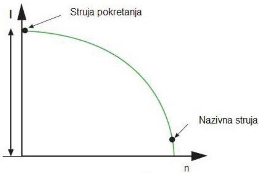
*Sl. 2.2. Strujna karakteristika kaveznog ASM [4]*
