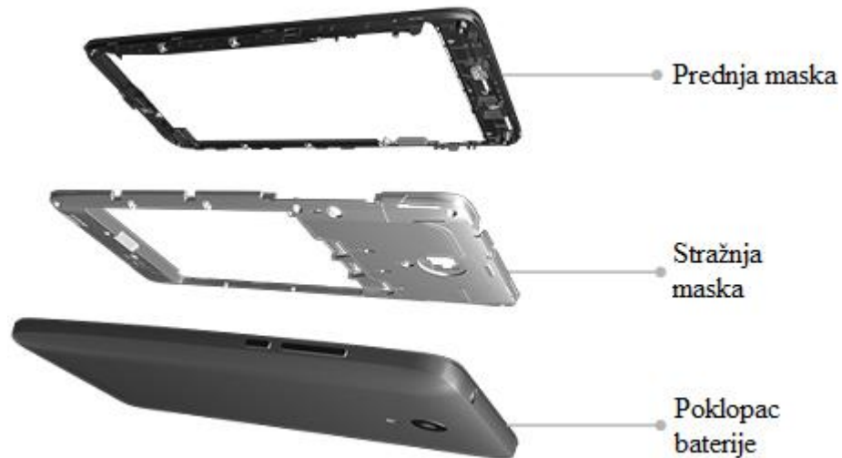
Slika 2. 5. Komponente kućišta mobilnog telefona
