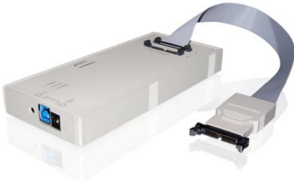
Sl. 6.1. Lauterbach uređaj za uklanjanje pogrešaka.
