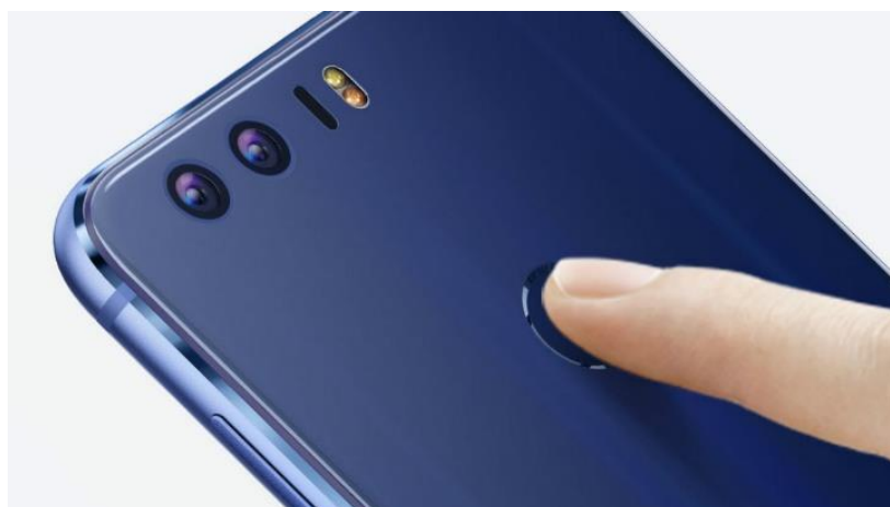
Sl. 2.2. Skener otiska prsta na mobilnom uređaju [7]
