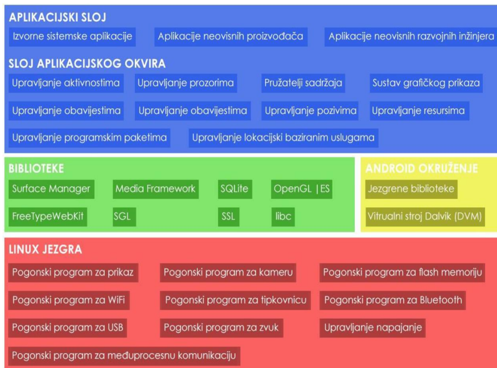
Slika 4.1. Arhitektura Android operacijskog sustava
