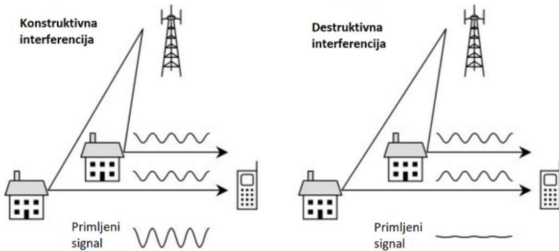
S1.3.3. Generiranje konstruktivne interferencije, destruktivne interferencije i slabljenja u višestaznom okruženju [4, str. 54]
