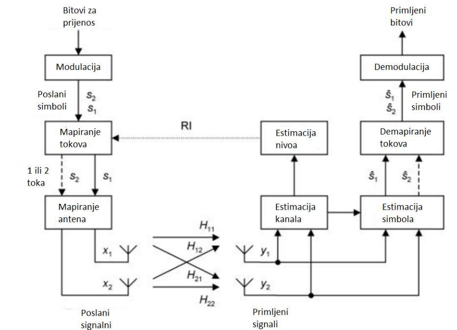
Sl.3.13. Princip rada 2x2 OL-MIMO sustava [4, str. 83]
