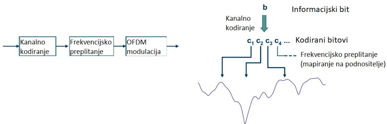
Sl.3.7. Kanalno kodiranje u kombinaciji s frekvenčijskim preplitanjem u svrhu frekvenčijskog diverzitija u OFDM prijenosu [2, str.40]
