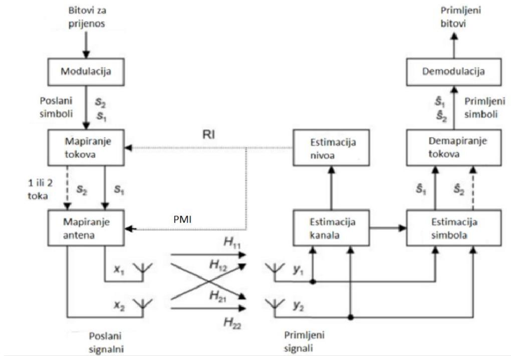
Sl.3.14. Princip rada 2x2 CL-MIMO sustava [4, str. 85]
