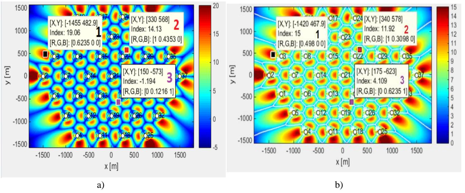
S1.4.3. Promjene uslijed makroskopskog gušenja i interferencije a) SINR vrijednosti; b) CQI vrijednosti
