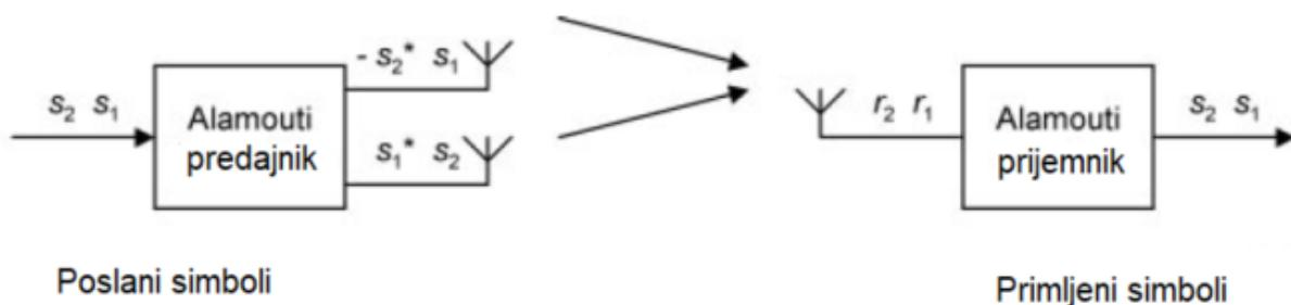
Sl.3.12. Princip rada Alamoutijeve tehnike za odašiljački diverziti otvorene petlje [4, str. 80]
