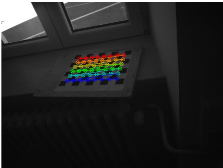
Slika 3.10 Slika dok je IR projektor prekriven
