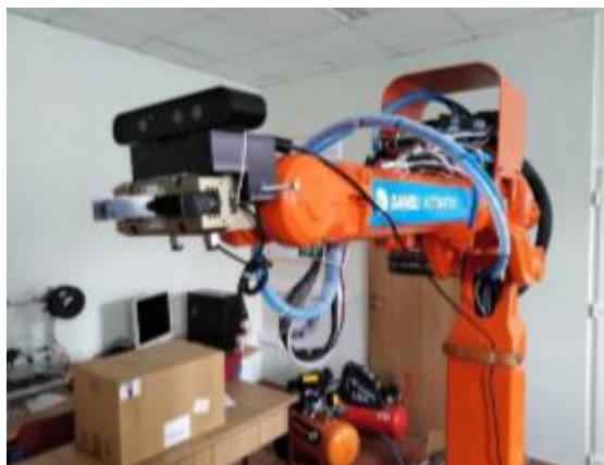
Slika 5.4. RGB-D kamera postavljena na hvataljku manipulatora
