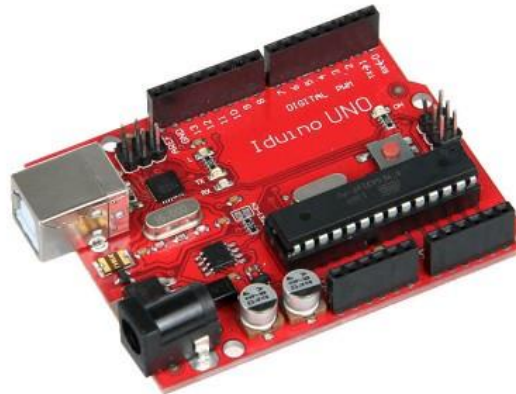
Sl.3.1. Arduino Uno razvojna pločica [5]
