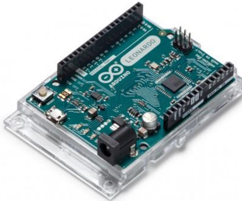
Sl. 4.6. Slika prikazuje korišteno Arduino Leonardo sučelje [7].
