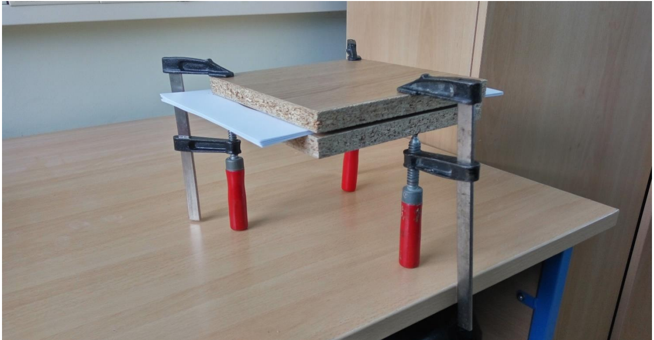
Slika 17. Stabilizacija pločastog kondenzatora drvenim oblogama i stegom
