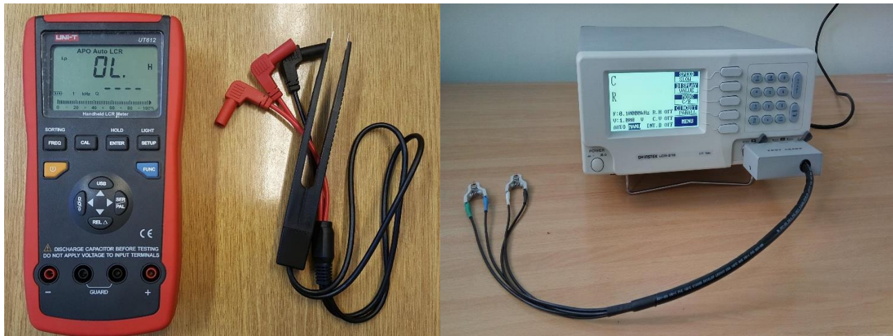
Slika 18. a) Unit 612 LCR, b) GW Instek 816 LCR
