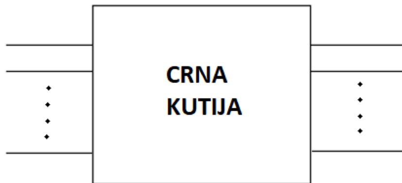
Slika 3.1. Shematski prikaz strujnog kruga kao crne kutije s beskonačno mnogo portova [19]
