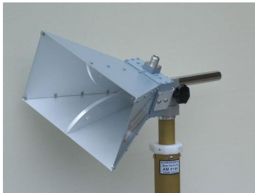
Slika 2.1. Pravokutna lijevak antena [7]
