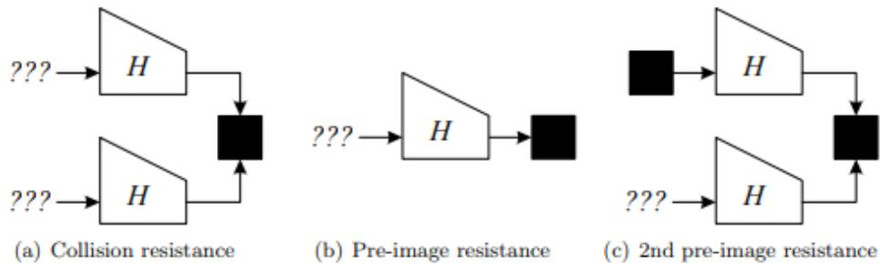
**Sl.2.2.** Grafički prikaz osnovnih svojstava *hash* funkcija: a) otpornost na sudare, b) *pre-image* otpornost i c) *second pre-image* otpornost [3]
