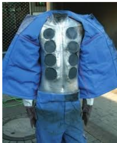
Slika 2.10. Raspored termopara na opremi RWEeurotest-a. [6]
