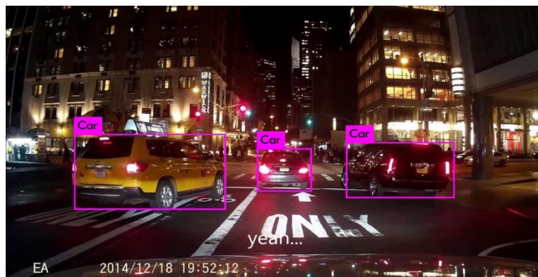
Slika 4.1. Detekcija objekata pomoću Yolo v2 algoritma po noći
