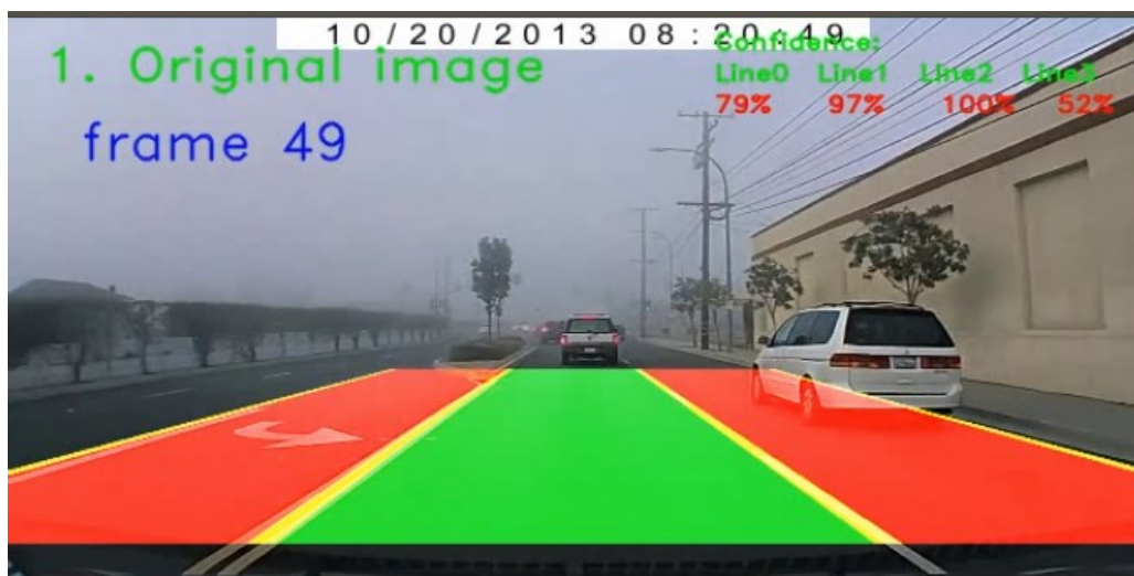
Slika. 4.2. Primjer točne detekcije linija na cesti na 49. okviru iz snimke „Foggy_YW_Straight_NT_1.mp4“
