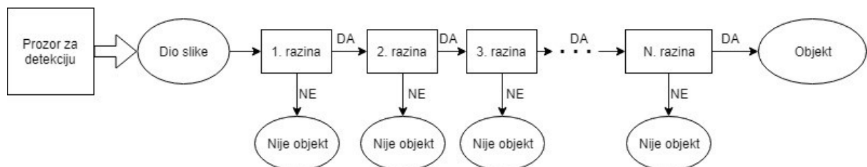
Sl. 2.3. Dijagram toka rada kaskade
