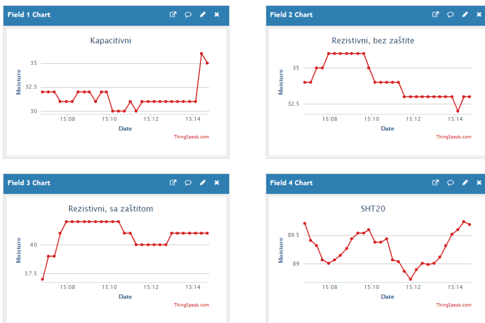
Slika 4.11. – Vrijednosti sa senzora za crvenicu za 35% referentnu vlažnost
