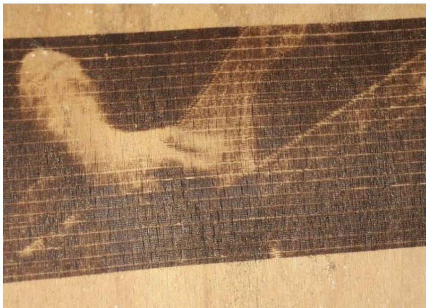
Slika 4.5 Ispis na drvo niskom brzinom
