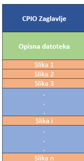
Slika 2.5. Izgled strukture CPIO arhive
