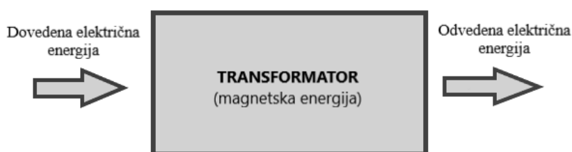
Slika 2.7. Pretvorba energije u transformatoru
