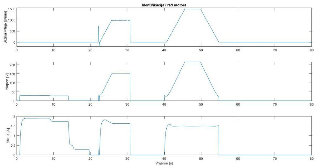
**Slika 4.11.** Postupak identifikacije motora uz estimaciju brzine vrtnje
