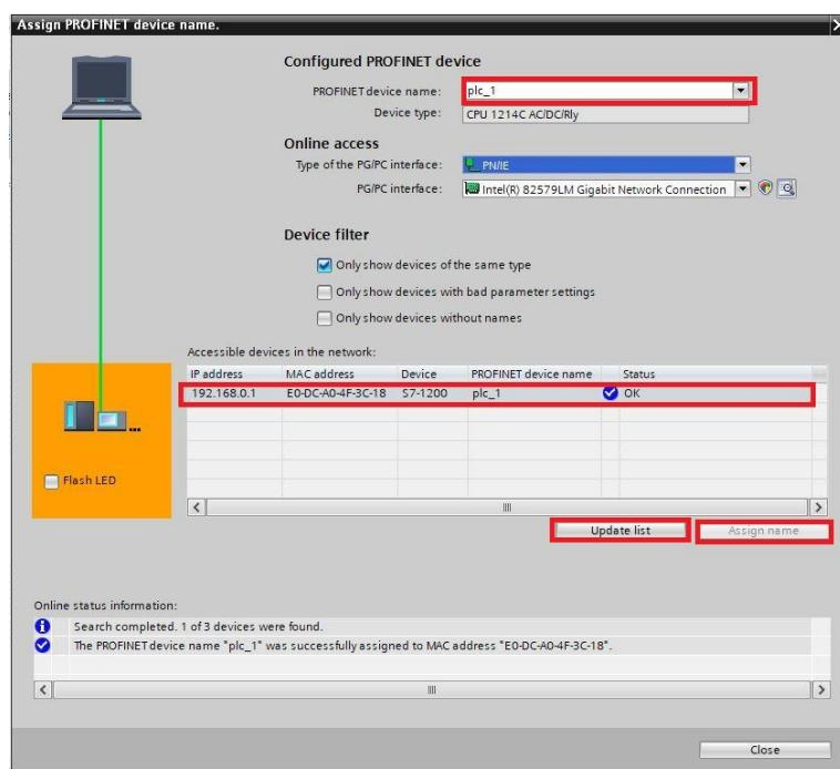
Slika 4.34. Dodjeljivanje imena i IP adrese PLC uređaju
