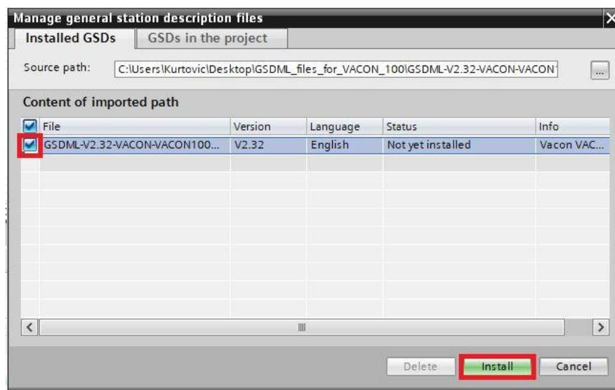
**Slika 4.27.** Instaliranje GSD datoteke frekvencijskih pretvarača VACON 100
