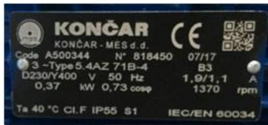
*Slika 3.2. Natpisna pločica asinkronog motora proizvođača Končar*
