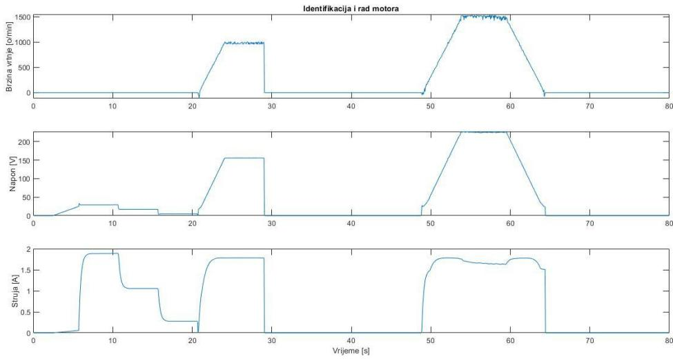
**Slika 4.10.** Postupak identifikacije motora bez estimacije brzine vrtnje
