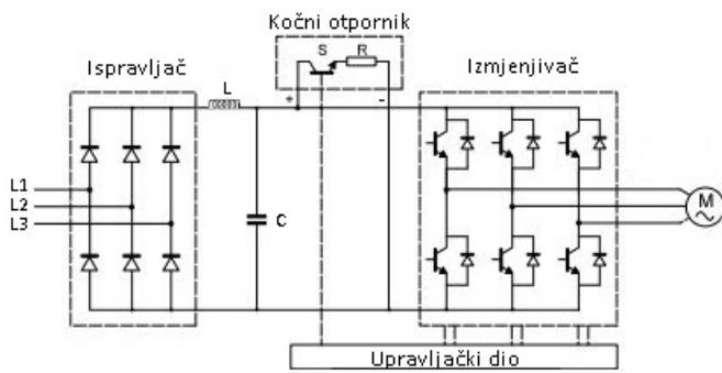
Slika 3.3. Shema najčešće korištenog frekvencijskog pretvarača [24]
