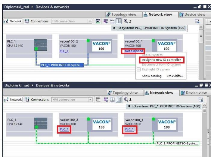
*Slika 4.32. Dodjeljivanje PLC-a uređaja za upravljanje frekvencijskim pretvaračima*
