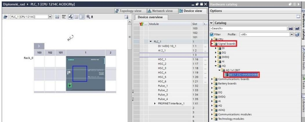
*Slika 4.20. Odabir i dodavanje signalne pločice u projekt*
