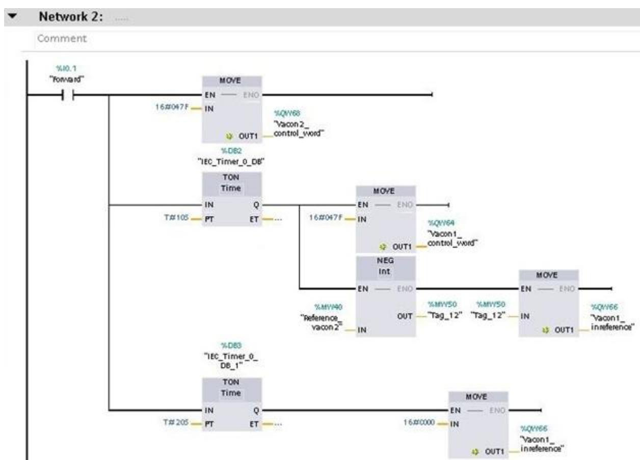
Slika P3.5. Realizacija automatiziranog elektromotornog pogona (primjer 1)
