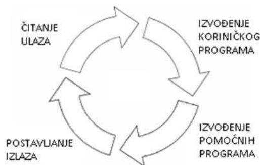
*Slika 3.10. Ciklički princip rada PLC-a*
