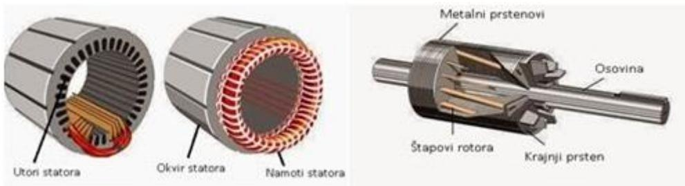
**Slika 3.1.** Stator i rotor asinkronog motora [21]
