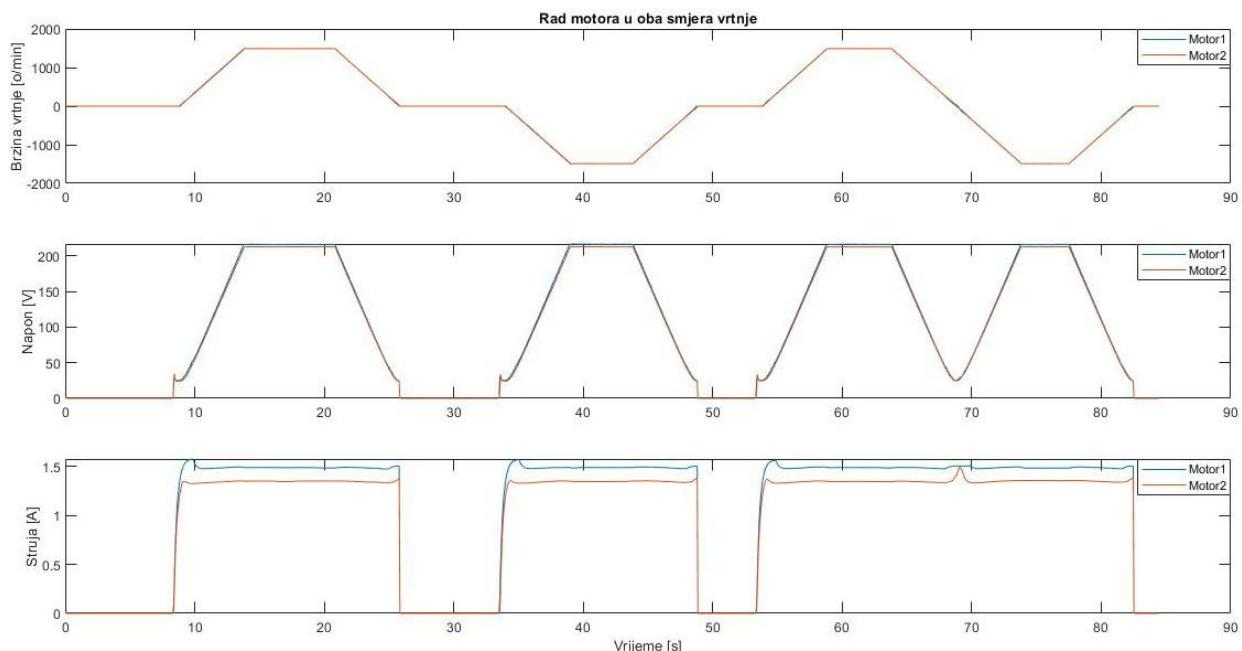
*Slika 5.2. Rad motora upravljenih putem PROFINET komunikacijskog protokola*
