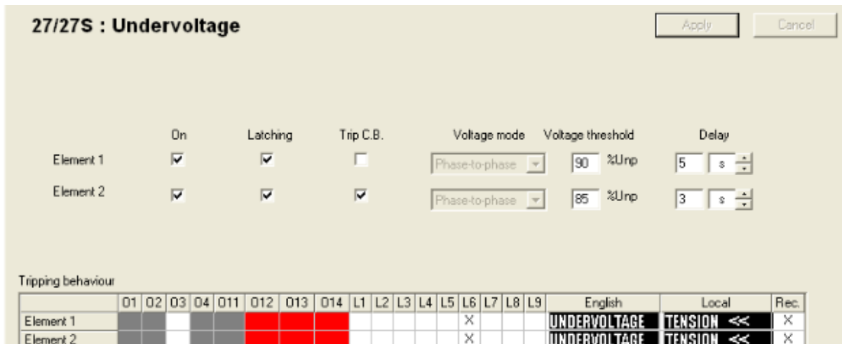
Slika 6.9 Podešavanje podnaponske zaštite
