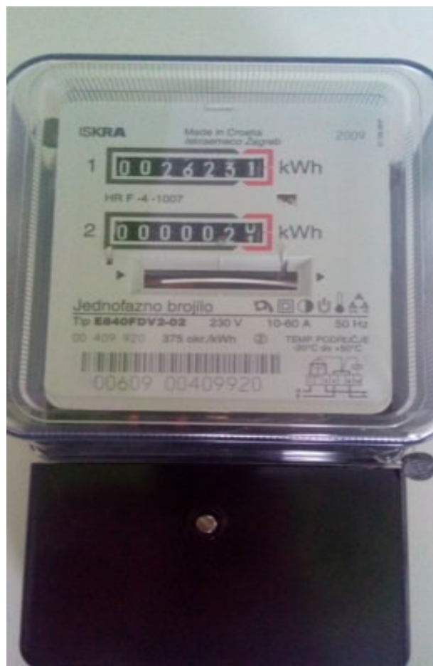
Slika 2.4: Električno jednofazno dvotarifno brojilo [2]
