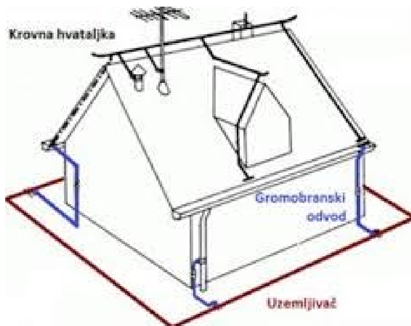
Slika 2.6: Shema gromobranske instalacije [3]
