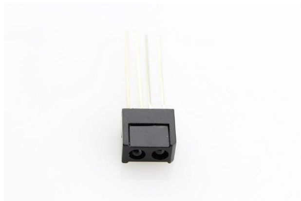
Sl. 2.7. Infracrveni senzor ST188
