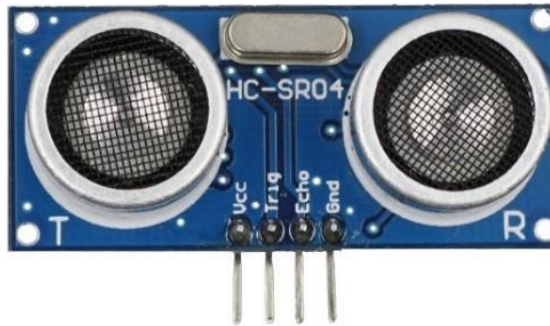
Sl. 2.6. Ultrazvučni modul HC-SR04
