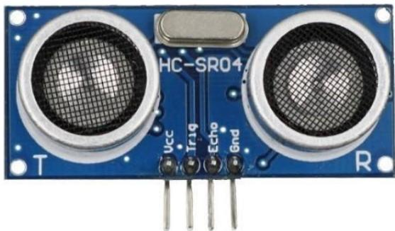
Sl. 2.6. Ultrazvučni modul HC-SR04
