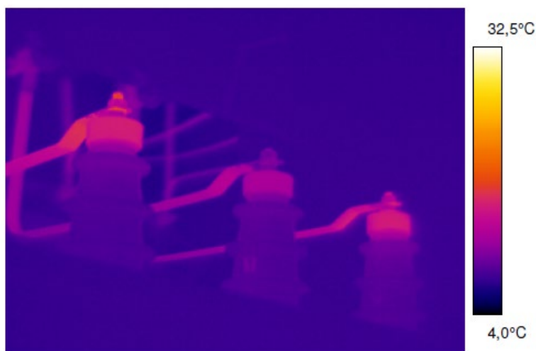
Slika 7.2. Odabir preširokog mjernog opsega (level/span), [9]
