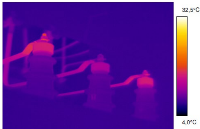
Slika 7.2. Odabir preširokog mjernog opsega (level/span), [9]
